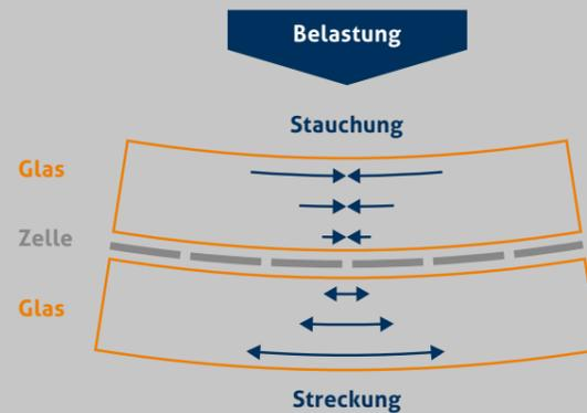
Bei Glas-Glas-Modulen werden die Zellen in der neutralen Faser nur gebogen, nicht gestreckt bzw. gestaucht. Dies verhindert Zellrisse und Hotspots.
