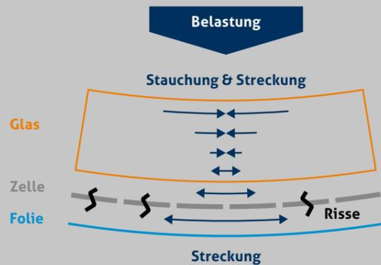
Bei der Belastung von Glas-Folie-Modulen kommt es zu Zellrissen. Diese mindern den Ertrag des Photovoltaikmoduls dauerhaft.
